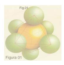
O SF<sub>6</sub> é o melhor isolante elétrico que se conhece. À pressão atmosférica, o SF<sub>6</sub> têm um dielétrico de capacidade resistiva que é 2.5 vezes melhor que a do ar. À pressão de 3 a 5 bar, que é a pressão usualmente aplicada aos equipamentos elétricos das subestações, suas propriedades dielétricas são dez vezes melhores que as do ar.
