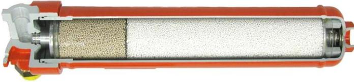
Com o filtro de secagem (umidade) os produtos gasosos em decomposição e a umidade, podem ser absorvidos com toda a segurança. O filtro utilizado é preenchido com Al<sub>2</sub>O<sub>3</sub> e com uma peneira molecular. A troca do filtro pode ser feita com muita facilidade.
