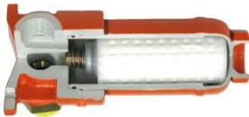
O filtro de partículas serve para filtrar partículas e produtos em decomposição compactos do gás SF<sub>6</sub>. A vela do filtro é dobrada em um cilindro com um corte diagonal em forma de estrela. É alcançada uma retenção de 100% a partir do tamanho  $\geq 1,0 \mu\text{m}$  de uma partícula.
