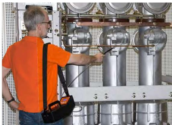
A extensão de sensor de medição (inclusa no escopo de fornecimento), que pode ser instalada entre o aparelho e o sensor de medição, se necessário, permite a realização de medições em pontos de difícil acesso.
