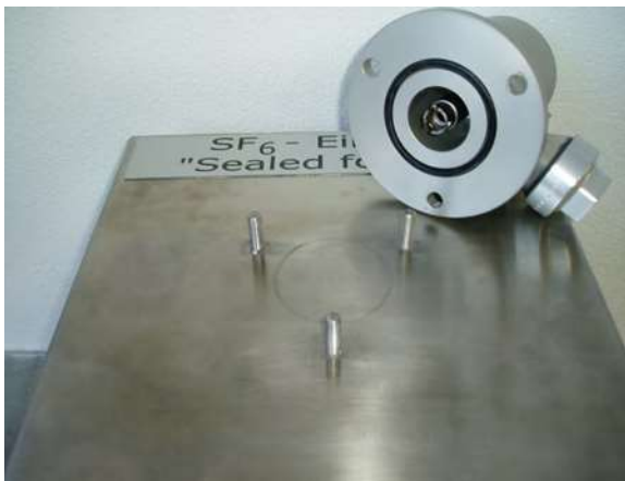
Fixação do pino antes da montagem na superfície
