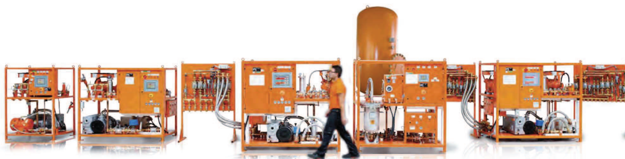
Solução completa de linha com unidade central, tanque de armazenamento e diversas estações de trabalho.
