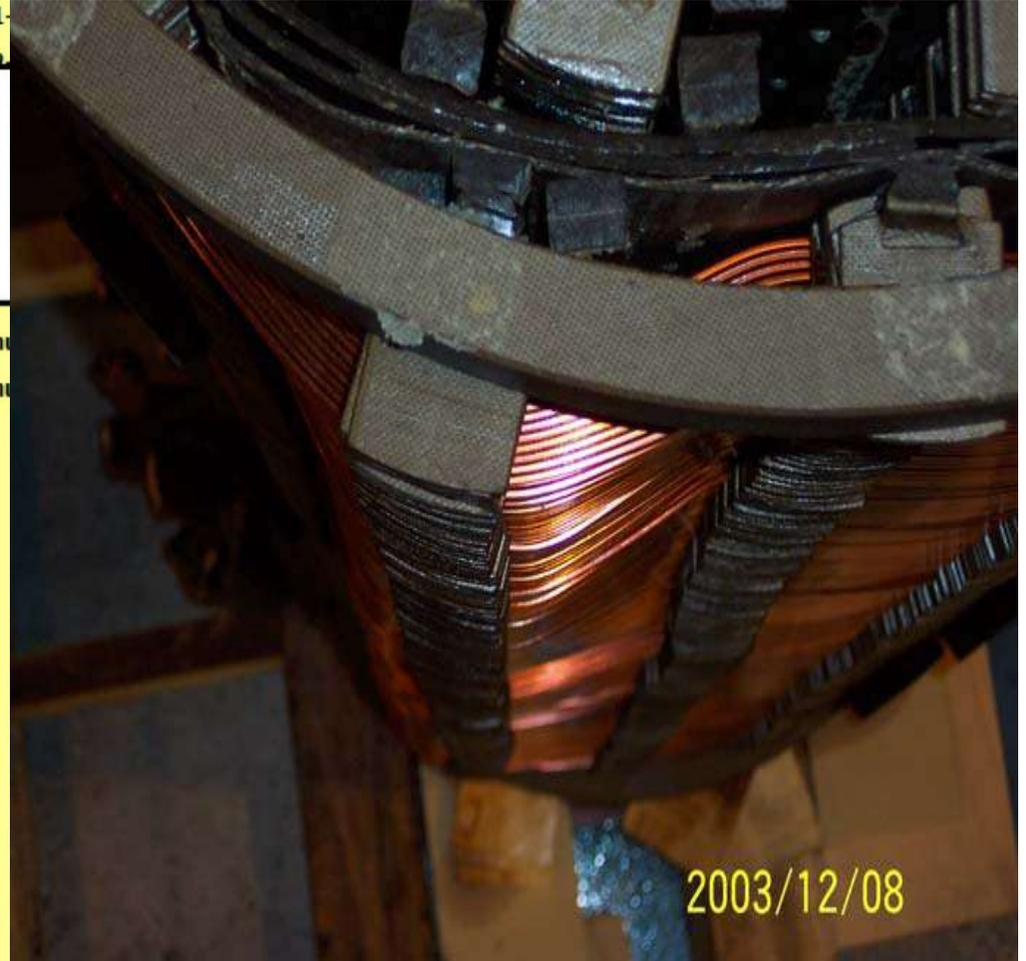
Detectado através de deslocamento de pico ressonante na faixa de 250kHz, Que é característico de problemas na bobina.
