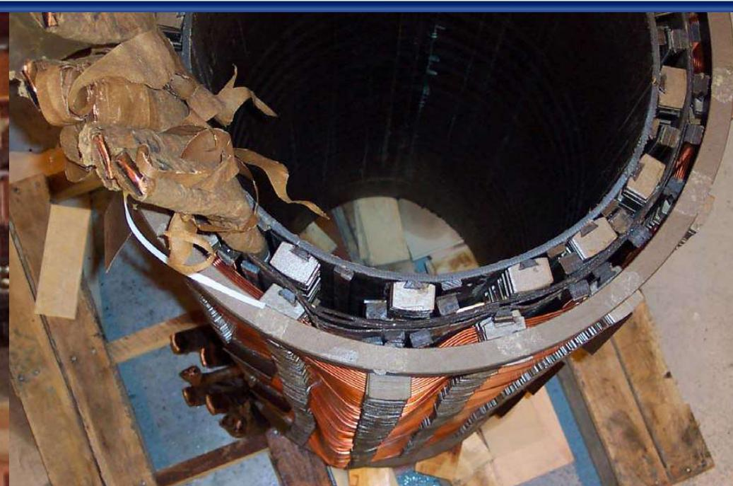
Os tipos de problemas apresentados não são detectáveis com outros tipos de testes, pois as características elétricas não sofreram alteração. O Ensaio de varredura em frequência pode detectar este problema.
