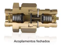
Acoplamentos DILO permitem estabelecer-se uma conexão simplesmente rosqueando duas partes de acoplamento uma na outra. Antes do fechamento da selagem metal-a-metal o acoplamento estanque à pressão e vácuo já está selado através de um O-Ring. Ao separar-se ambas as partes de acoplamento o mesmo O-Ring previne a perda de gás enquanto as válvulas auto-blocantes se fecham.
