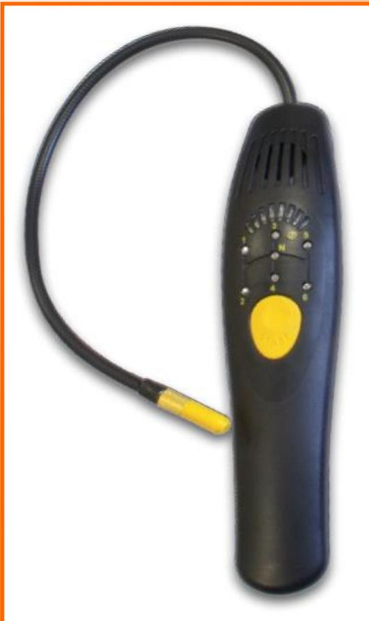
Para detecção rápida de vazamentos de gás
