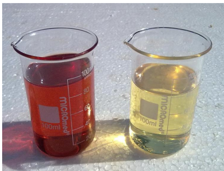
Aspecto médio de óleo de transformador antes e depois da regeneração
